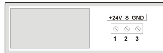
RYS 1. - SYGNAŁY NA BLOCZKU PRZYŁĄCZENIOWYM ( WIDOK OD TYŁU )
